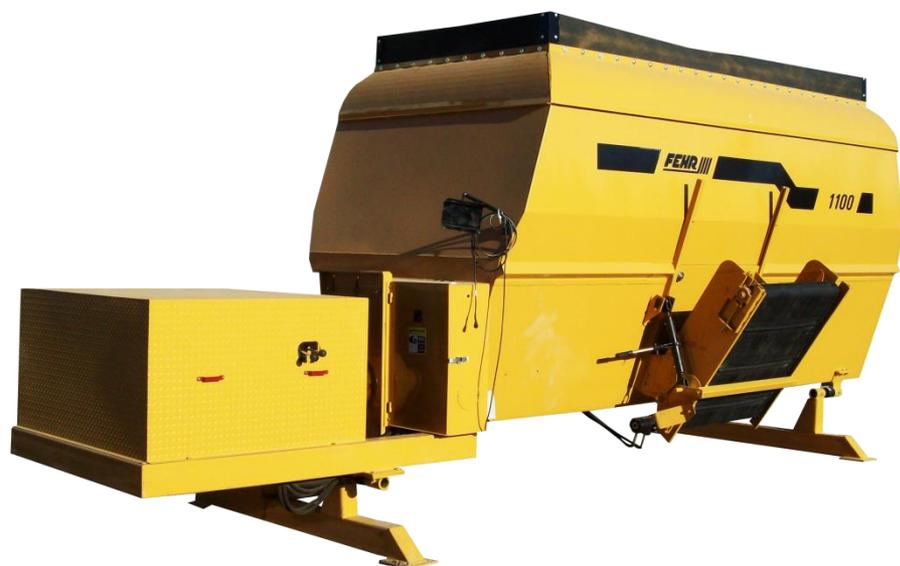
El mezclador horizontal tiene una escalera en unos de los costados que nos sirve para checar, verificar y asegurar que el mezclado del forraje este bien mezclado y picado, también sirve para revisar que no exista anomalías en la maquinaria.
